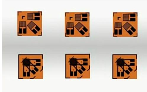
Le deformazioni per i test dei PCB sono utilizzati per misurare varie proprietà meccaniche dei circuiti stampati, nei computer, nella strumentazione, nei prodotti digitali, negli elettrodomestici, nei dispositivi di controllo, nella valutazione qualitativa.
